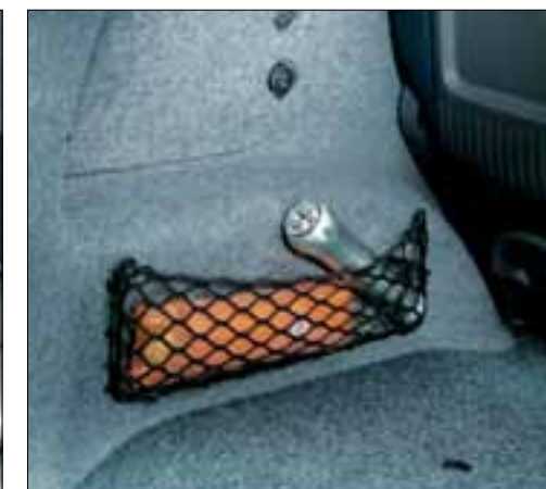
RETE TRATTENIMENTO SU PIANALE
